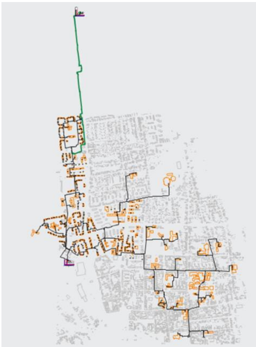
40. ábra A Zöld Fűtőmű távfűtési hálózatra csatlakozása (forrás: Kaposvári Vagyonkezelő Zrt. Távfűtési Üzeme)
